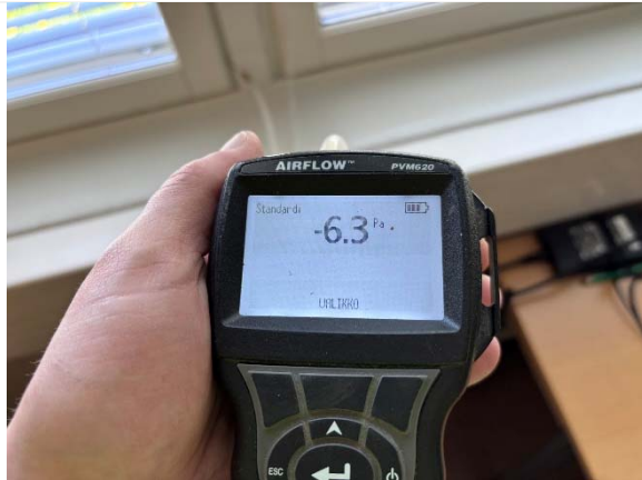
Kuva 2. Hetkellinen paine-ero mittauksen aikana.
