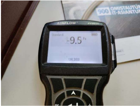
Kuva 35. Hetkellinen paine-ero mittauksen aikana.
