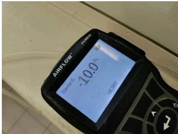
Kuva 19. Hetkellinen paine-ero mittauksen aikana.
