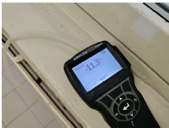
Kuva 3. Hetkellinen paine-ero mittauksen aikana.
