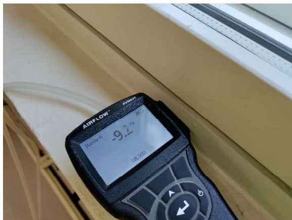
Kuva 23. Hetkellinen paine-ero mittauksen aikana.
