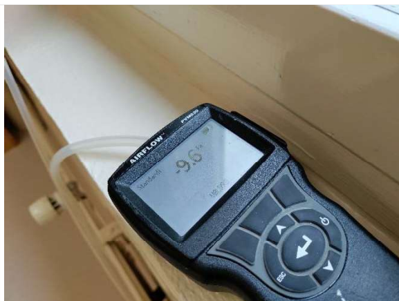
Kuva 25. Hetkellinen paine-ero mittauksen aikana.
