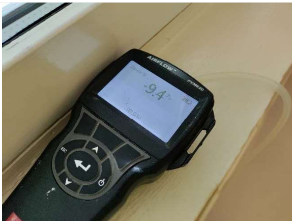
Kuva 37. Hetkellinen paine-ero mittauksen aikana.
