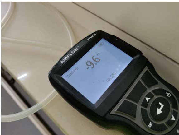
Kuva 49. Hetkellinen paine-ero mittauksen aikana.
