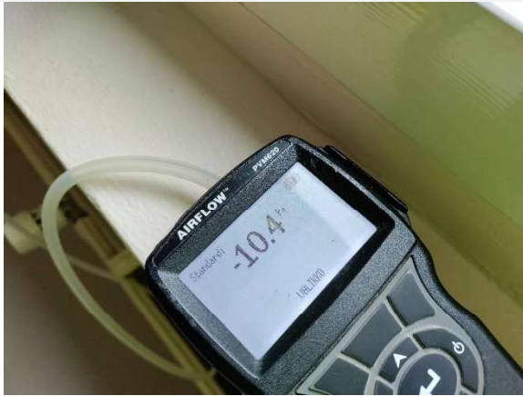
Kuva 31. Hetkellinen paine-ero mittauksen aikana.
