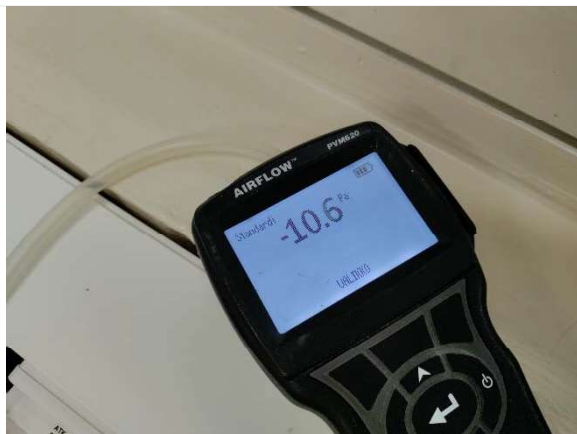
Kuva 1. Hetkellinen paine-ero mittauksen aikana.
