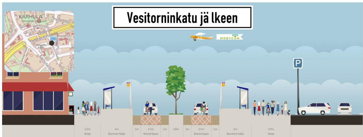
Kuva 27. Vesitorninkadun suunnitellut joukkoliikennepysäkit, jotka toteutetaan korotettuina ja katettuina ajorata-pysäkkeinä.
