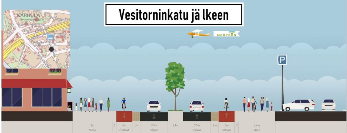
Kuva 24. Vesitorninkadun nykyinen ja suunniteltu poikkileikkaus (27 m) Ahlströmintien ja Vesivallinaukion välillä.
