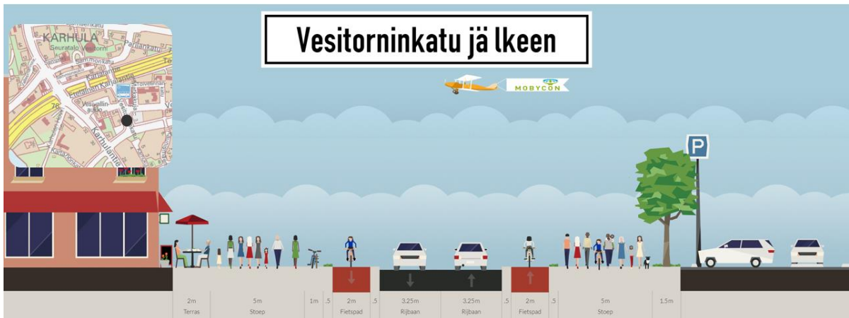
Kuva 25. Vesitorninkadun mahdollinen poikkileikkaus, jos ajokaistojen välisestä viherkaistasta luovutaan.
