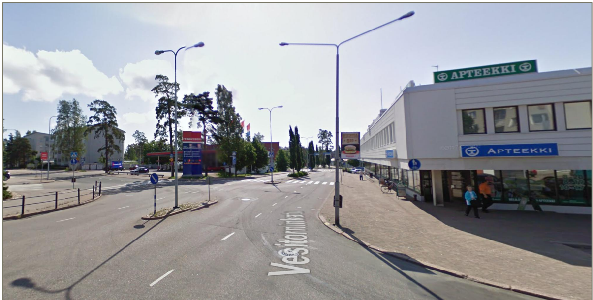
Kuva 12. Vesitorninkadun länsipuolen yhdistetty pyörätie ja jalkakäytävä on alimitoitettu, eikä vastaa mm. eroteltutarpeiltaan tarkoitustaan (kuva: Google Street View).
