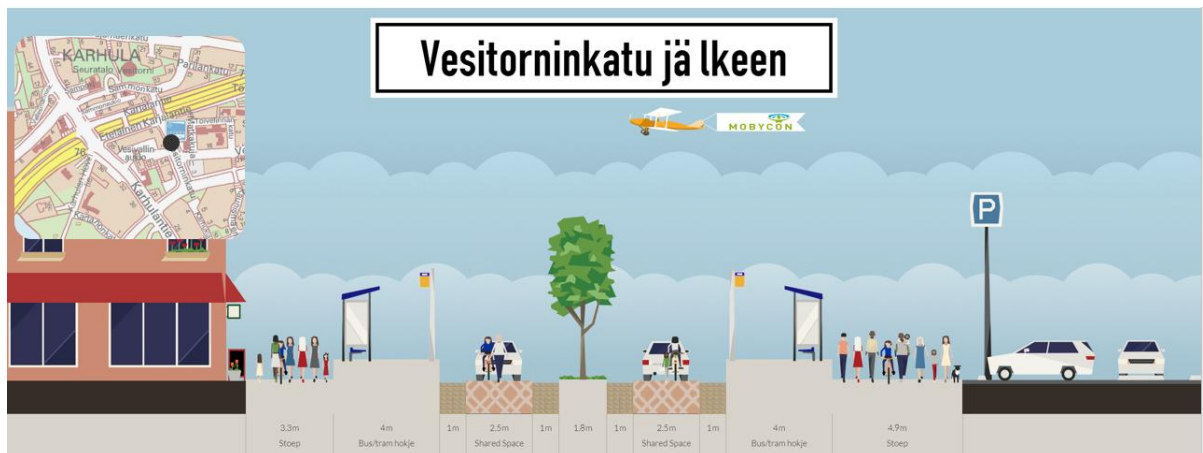
Kuva 28. Vesitorninkadun suunnitellut joukkoliikennepysäkit, jotka toteutetaan korotettuina ja katettuina ajorata-ajonvapaana.
