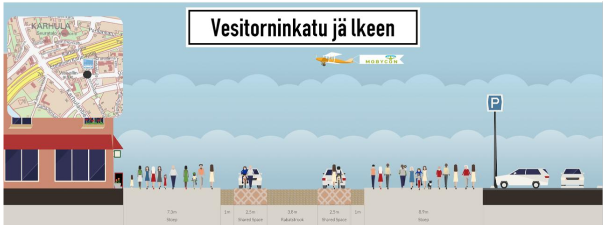
Kuva 27. Vesivallinaukion suunniteltu poikkileikkaus, jossa ei ole tasoeroja.
