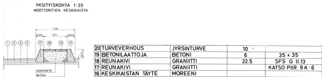
Kuva 7: Karhulan kanjonin moottoritien keskikaista. Päälle on myöhemmin asennettu betonikaide-elementit.
