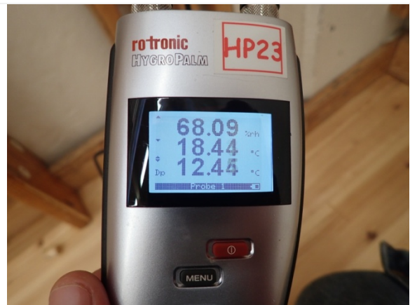
Kuva 7. Alapohjan kosteusmittauksen tulos
