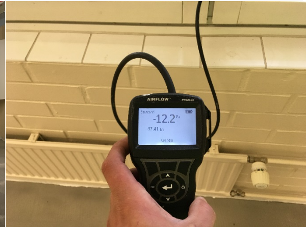
Kuva 4. Luokkatila 181 alipaine merkkiainemittauksen aikana
