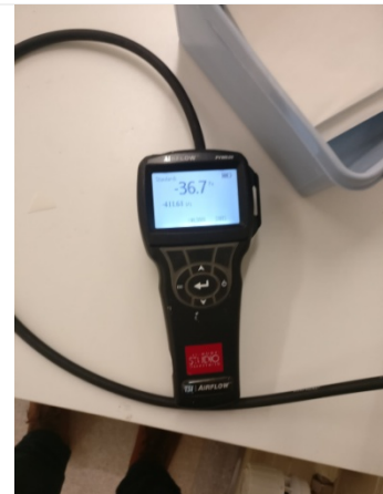
Kuva 2. Ulkovaipan yli mitattu paine-ero mittauksen yhteydessä
