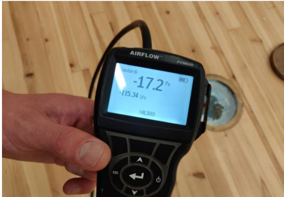
Kuva 6. alapohjarakenteen paine-eromittaus -17 Pa
